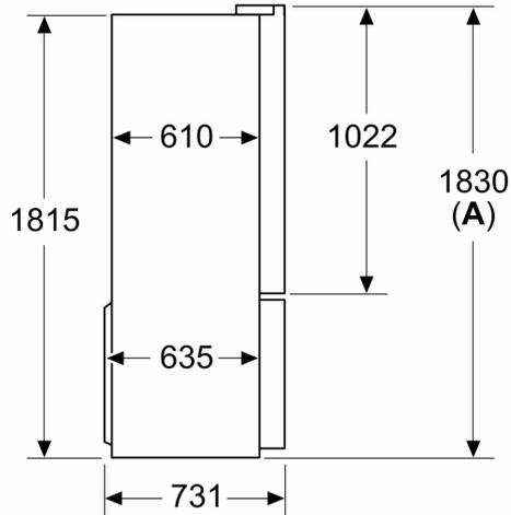
**A:** La parte frontal es ajustable desde 1830-1847 mm, con las patas de nivelación totalmente extendidas
