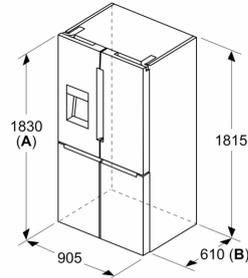
**A:** La parte frontal es ajustable desde 1830-1847 mm, con las patas de nivelación totalmente extendidas
