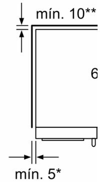
\* Si el aparato se coloca en una cocina, la distancia mínima debe ser de 76 mm.
