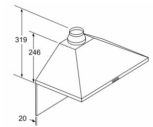
Si se usa una pared trasera, se debe tener en cuenta el diseño del aparato. Dimensiones en mm
