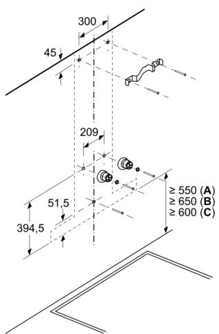
**A:** Eléctrico**B:** Gas: desde el borde superior del soporte para ollas**C:** Eléctrico: para Australia y Nueva Zelanda
