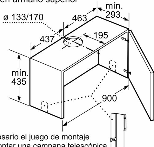
Es necesario el juego de montaje para montar una campana telescopica de 90 cm en un armario superior de 90 cm de ancho. Dimen.
