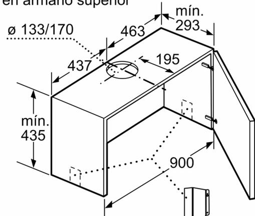
Es necesario el juego de montaje para montar una campana telescópica de 90 cm en un armario superior de 90 cm de ancho.
