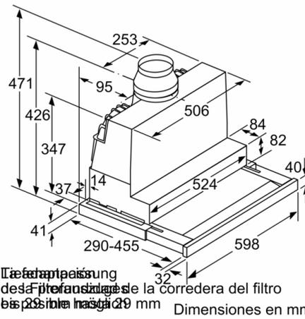
La altura de la tapa de ajuste de la corredera del filtro es de 29 mm.
