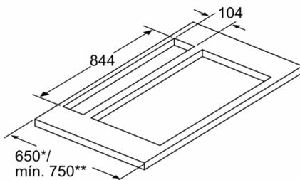
Instalar solo un lado del aparato junto a un mueble alto o pared con una distancia de min 50 mm.
