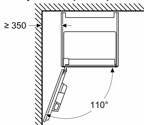
Si se utiliza el limitador de bisagra de 92°, la distancia mín. hasta la pared es de solo 100 mm
