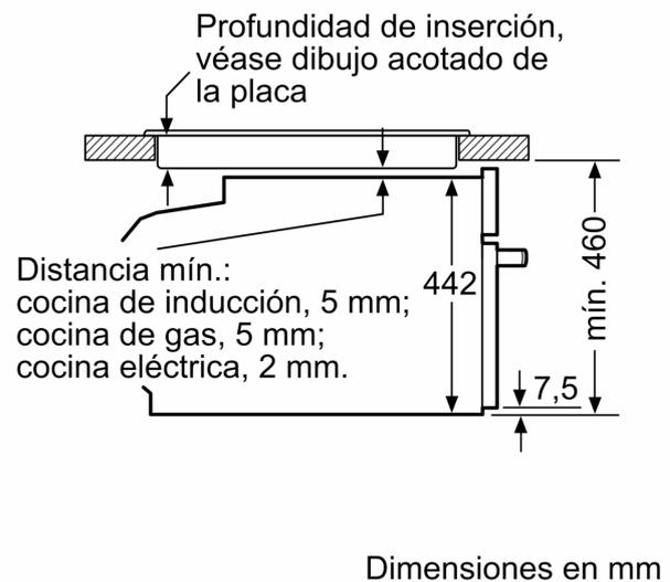
Si se instala el aparato compacto debajo de una placa, se debe respetar el siguiente grosor de encimera (incl., dado el caso, la estructura de soporte).
