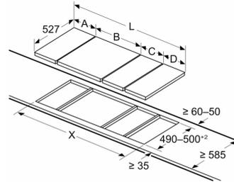
Si se montan dos o más elementos uno al lado del otro, son necesarios uno o varios kits de montaje (para 2 elementos, 1 kit de montaje; para 3 elementos, 2 kits de montaje, etc.)
