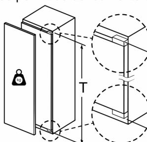
Las puertas del mueble montadas que exceden el peso permitido pueden provocar daños y deterioro funcional a la bisagra.
