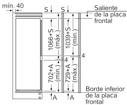
Las dimensiones de la puerta del mueble indicadas corresponden a una junta de puerta de 4 mm. Dimensiones en mm
