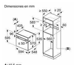
A: 19,5 mm B: Espacio para la conexión del aparato 320 x 115 mm
