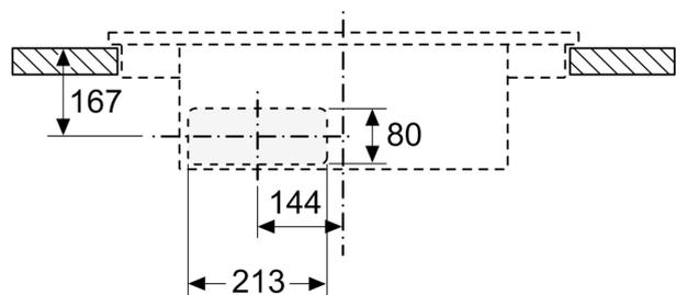
A: Direkt an der Rückseite angeschlossen
