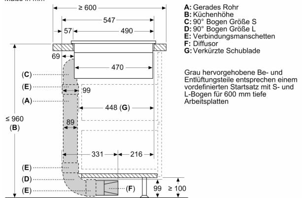
Grau hervorgehobene Be- und Entlüftungssteile entsprechen einem vordefinierten Startset mit S- und L-Bogen für 600 mm tiefe Arbeitsplatten
