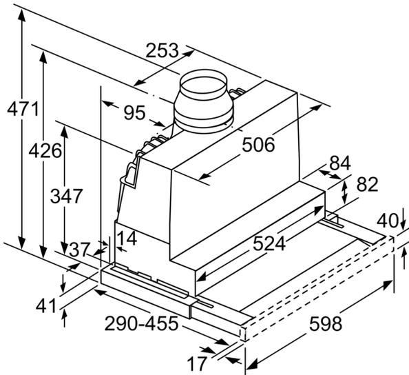
Tiefenanpassung des Filterauszuges bis 29 mm möglich
