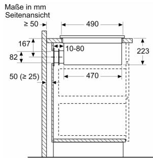
Bei der Installation direkt an einer nicht isolierten Außenwand ( $\mu \geq 0,5 \text{ W/m}^2\text{K}$ ) empfehlen wir die Verwendung von Konfigurationen mit teilweise oder vollständig kanalisierten Rezirkulationen.
