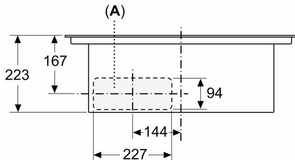
A: Direkt an der Rückseite angeschlossen
