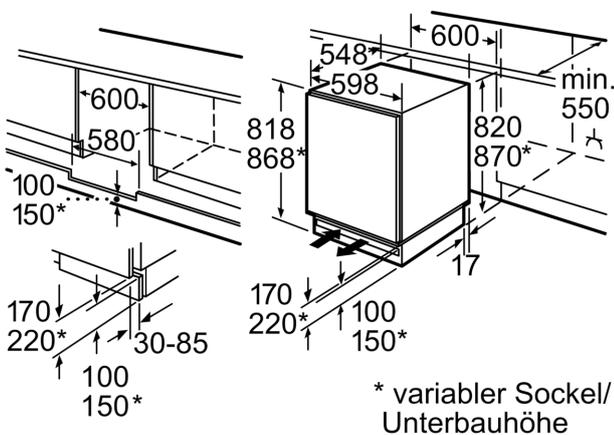
Platz für elektrischen Anschluß seitlich rechts oder links neben dem Gerät.
