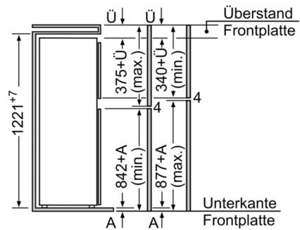
Die angegebenen Möbeltürmaße gelten für eine Türfuge von 4 mm. Bei Verwendung einer anderen Fugenbreite (max. 14 mm) müssen die Maße angepaßt werden.
