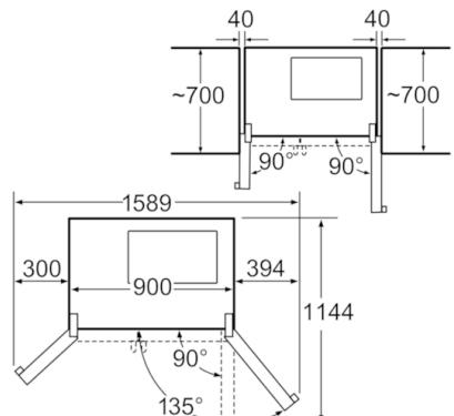
Schalen ausziehbar bei 90° geöffneter Tür.
