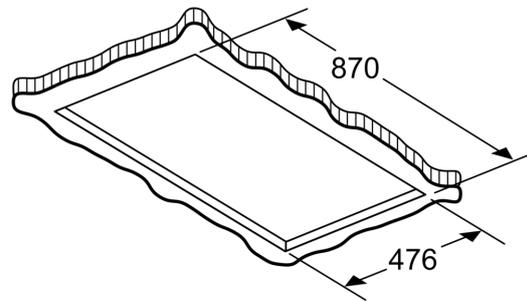
Für die Befestigung der Dunstabzugshaube ist ein geeignetes, tragendes Untergerüst erforderlich. Das Gerät nicht direkt in Gipskartonplatten oder ähnliche Leichtbaustoffe montieren.
