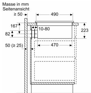
Bei der Installation direkt an einer nicht isolierten Außenwand ( $\mu \geq 0,5 \text{ W/m}^2\text{-}^\circ\text{C}$ ) empfehlen wir die Verwendung von Konfigurationen mit teilweise oder vollständig kanalisierter Rezirkulation.
