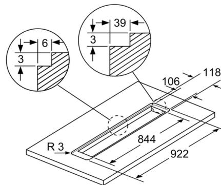
Für den flächenbündigen Einbau in Stein- und Granitarbeitsplatten
