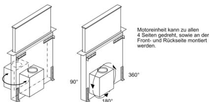
Motoreinheit kann zu allen 4 Seiten gedreht, sowie an der Front- und Rückseite montiert werden.
