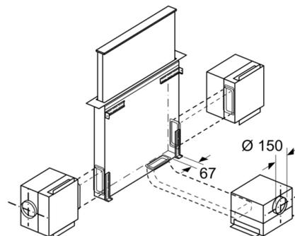
Motoreinheit kann mit maximal 3 m Abstand zum Gerät montiert werden. (Sonderzubehör erforderlich)
