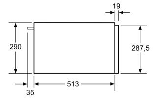
Über eine Wärmeschublade können Backöfen mit einer Gerätehöhe von 595 mm eingebaut werden.
