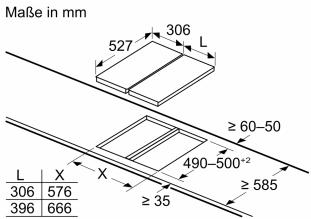
Bei Einbau von zwei oder mehr Elementen nebeneinander sind ein oder mehrere Montagesätze erforderlich (2 Elemente = 1 Montagesatz, 3 Elemente = 2 Montagesätze usw.)
