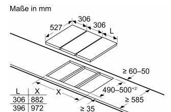
Bei Einbau von zwei oder mehr Elementen nebeneinander sind ein oder mehrere Montagesätze erforderlich (2 Elemente = 1 Montagesatz, 3 Elemente = 2 Montagesätze usw.)
