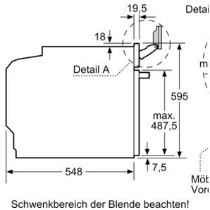
Wird das Gerät unter eingebaut, muss folgende Stärke (ggf. inkl. Unterbauch) beachtet werden.
