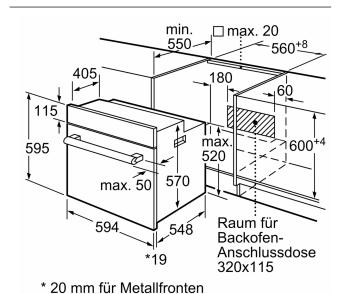
min. 550 560+8 20 405 180 60 115, 590 max. 595 (min. 575 max<sub>.</sub> 597) 520 max. 50 594 548 Raum für Backofen-\*19 Anschlussdose 320x115 \* 20 mm für Metallfronten
