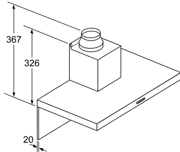
Bei Verwendung einer Rückwand
