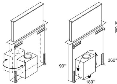
Motoreinheit kann zu allen 4 Seiten gedreht, sowie an der Front- und Rückseite montiert werden.
