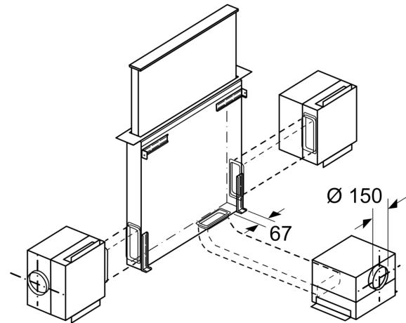
Motoreinheit kann mit maximal 3 m Abstand zum Gerät montiert werden.
