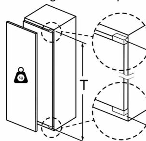
Monterede låger, som overskrider den tilladte vægt, kan medføre beskadigelser og reduceret funktion af hængslerne.
