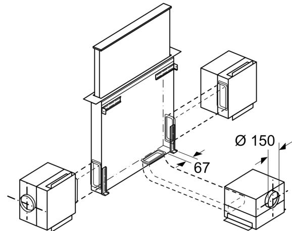
Motorenheten kan maksimalt monteres med en afstand på 3 m til apparatet.
