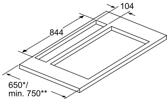
Installer kun apparatet ved siden af et højskab eller en væg i den ene side med en afstand på min. 50 mm
