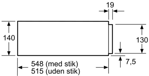
Over en varmeskuffe kan kompakte ovne med en højde på 455 mm indbygges. Mellemhylde er ikke nødvendig.
