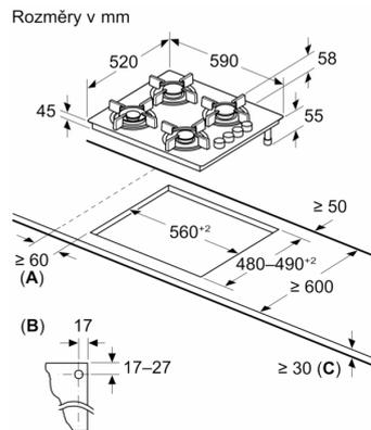
**A:** Min. vzdálenost od výřezu varného panelu ke stěně
