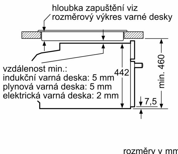
Pokud je kompaktní spotřebič vestavěný pod varnou deskou, musí být dodržená následující tloušťka pracovní desky (příp. včetně nosné konstrukce).
