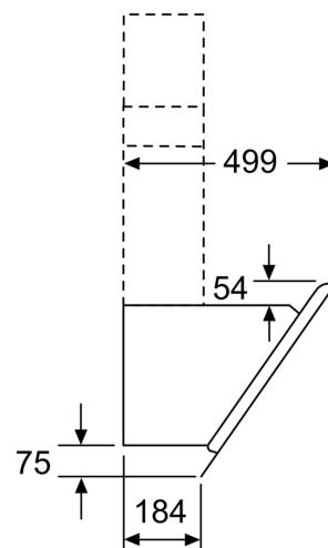
Измерване в мм
