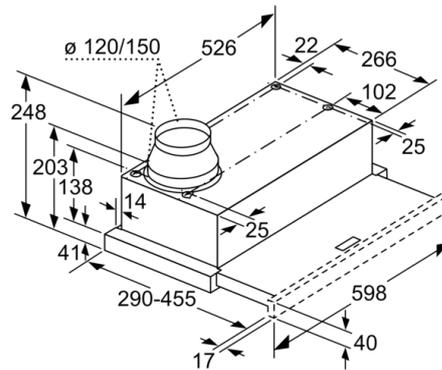
Адаптиране на дълбочини на филтърната част възможно до 29 мм измерване в мм
