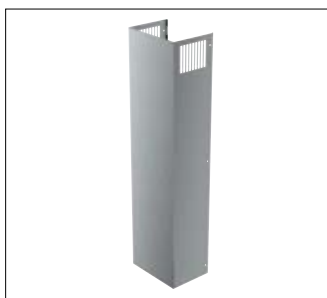
DWZ 0AX5K0: przedłużenie komina 1000 mm, stal szlachetna. Możliwość wydłużenia całkowitej wysokości urządzenia o maks. 530 mm. Do obiegu zamkniętego lub otwartego. Przedłużenie szczelinami do pracy w obiegu zamkniętym.
