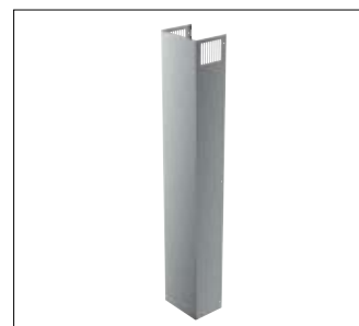
DWZ 0AX5L0: przedłużenie komina 1500 mm, stal szlachetna. Do okapów kominowych naściennych. Możliwość wydłużenia całkowitej wysokości urządzenia o 1030 mm. Do obiegu zamkniętego lub otwartego. Przedłużenie szczelinami do pracy w obiegu zamkniętym.
