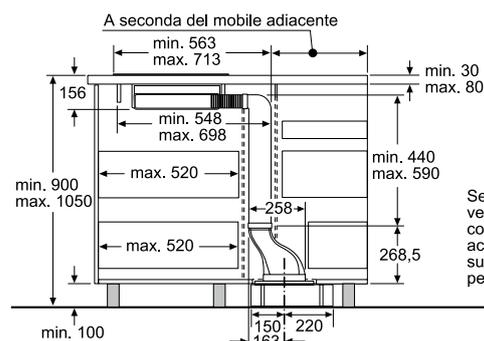
Se si utilizzano 2 unità di ventilazione in combinazione con la modalità di espulsione accertarsi che ci sia uno spazio sufficiente per il condotto per l'espulsione dell'aria.
