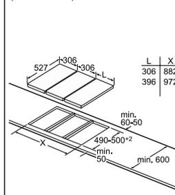
Per il montaggio di due elementi Domino accostati, sono necessari uno o più listelli di congiunzione (2 elementi 1 listello, 3 elementi 2 listelli di congiunzione).
