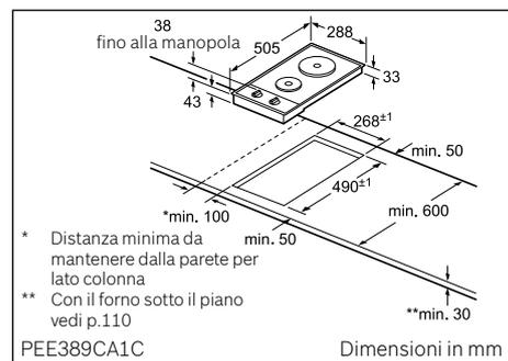
Per il montaggio di due elementi Domino accostati a un piano di cottura sono necessari due listelli di congiunzione (HEZ394301).
