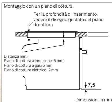
Se l'apparecchio viene montato sotto un piano di cottura deve essere rispettato il seguente spessore del piano di lavoro (event. incl. sottostruttura).
