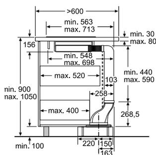
Se si utilizzano 2 unità di ventilazione in combinazione con la modalità di espulsione accertarsi che ci sia uno spazio sufficiente per il condotto per l'espulsione dell'aria.
