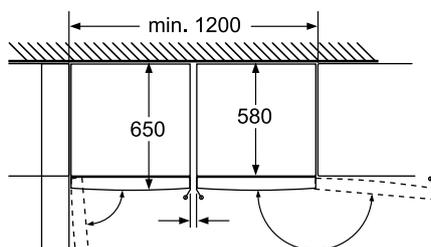
Schalen voll herausziehbar, wenn das Gerät direkt an einer Wand platziert ist.
