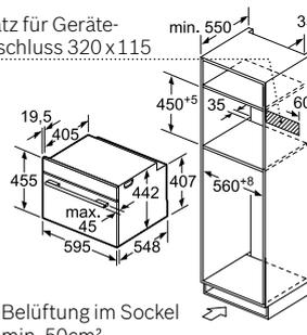
Belüftung im Sockel min. 50cm<sup>2</sup>
