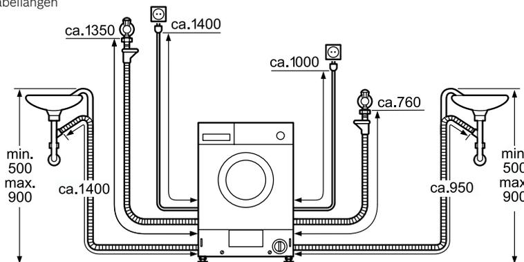
Wenn der montierte AquaStop-Zulaufschlauch zur Installation nicht ausreichen sollte, besteht die Möglichkeit, diesen mit der Anschlussgarnitur WMZ2380 (Länge 2,5 m) zu verlängern.
