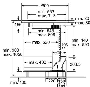
Bei Verwendung von 2 Gebläseeinheiten in Kombination mit Abluft ist der Platzbedarf für die Abluftführung zu beachten.
