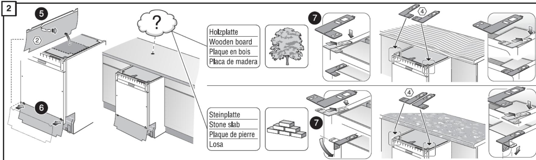
步驟五~七、區分檯面種類，需要時可加裝機體固定片 **安裝包(4)**，並請注意安裝方向與方式，若為人造石檯面，將固定片依圖示方向摺到定位。
