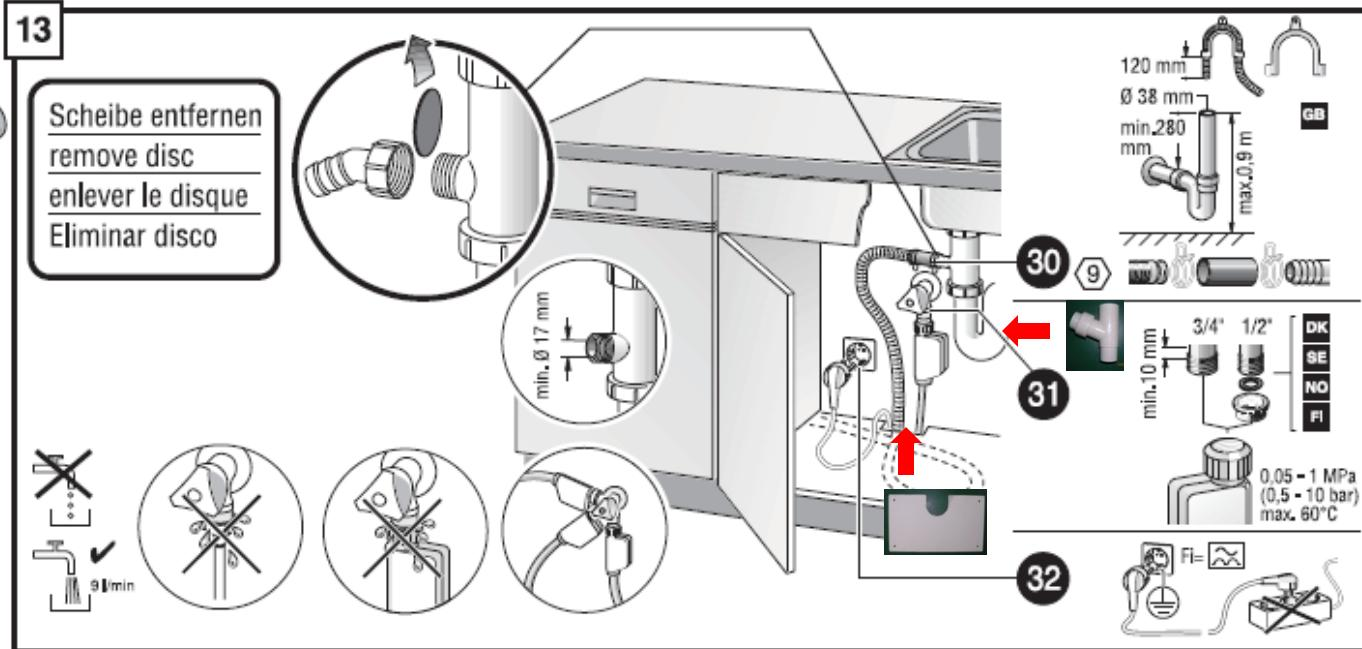
步驟三十、**安裝排水管**(可利用附贈之塑膠排水三通，安插在原水槽排水管的適當位置)，如直接配置排水管，高度不可高於洗碗機。
