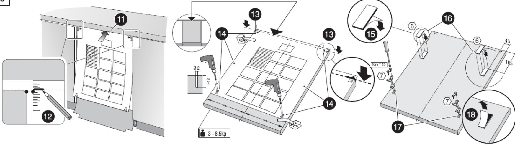
步驟十一~十二、貼上機器隨附之安裝施工圖，圖面上緣切齊檯面下緣，以鉛筆標出相鄰櫃門之高度。
