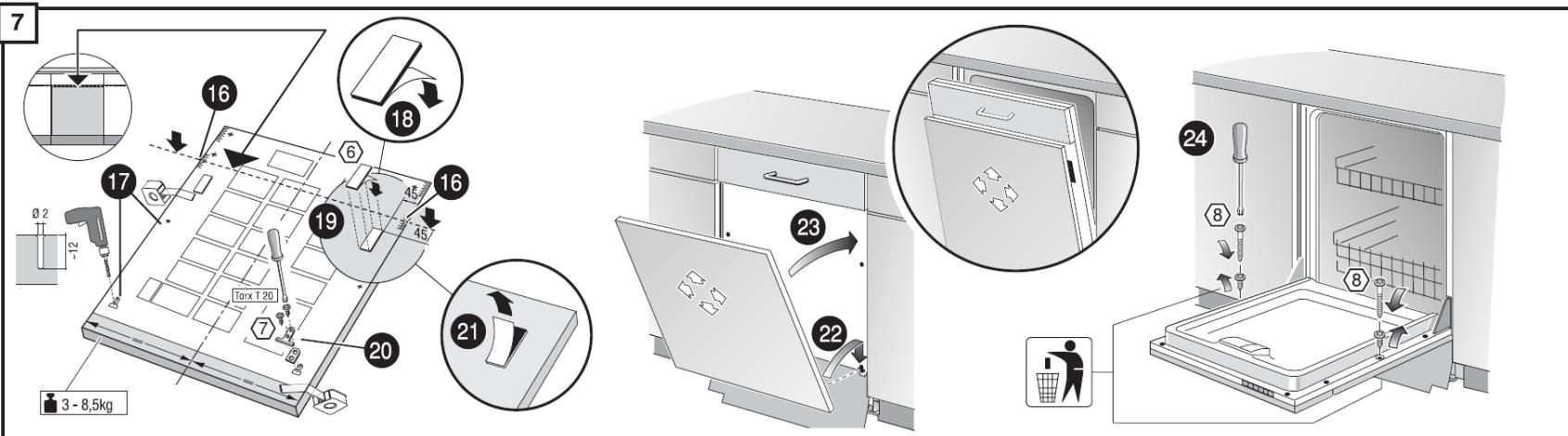
步驟十六、門板內側朝上，施工圖原先所標示刻度位置與門板上緣對齊(圖面凸出門板)，並以膠帶固定施工圖四角。
