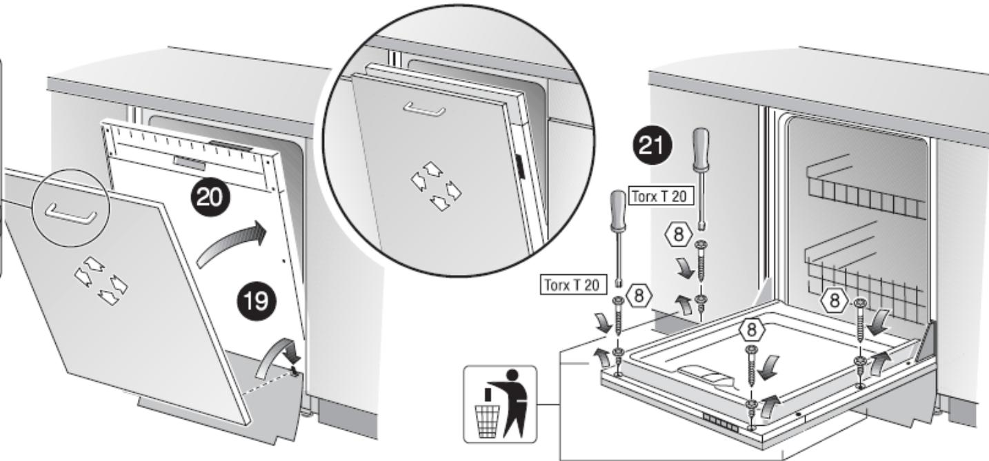
步驟十九、將門板下方的固定片崁入機器門板固定孔內，並向下推至定位。
