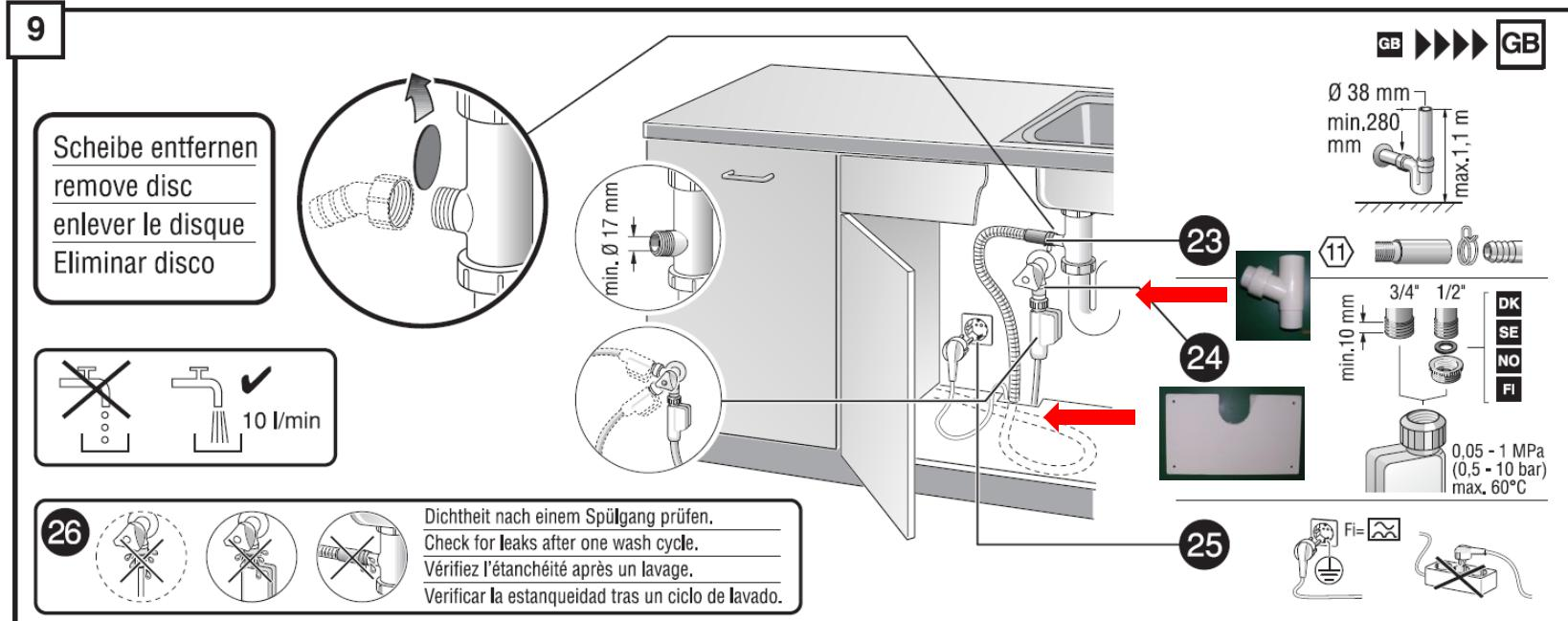
步驟二十三、**安裝排水管**(可利用附贈之塑膠排水三通，安插在原水槽排水管的適當位置)，如直接配置排水管，高度不得高於洗碗機。
