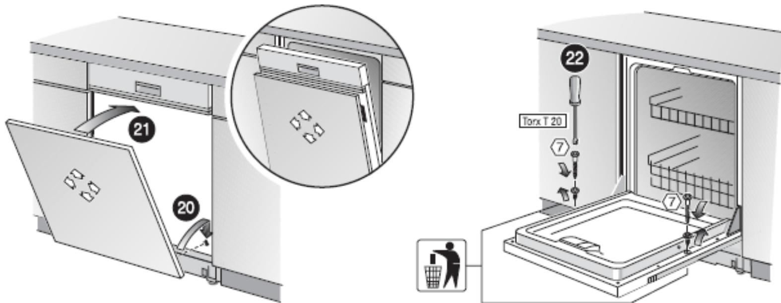
步驟二十、將門板下方的固定片崁入機器門板固定孔內，並向下推至定位。
