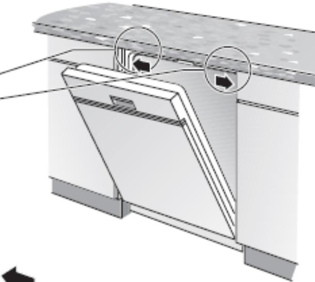
步驟二十四、用**安裝包(7b)**之兩顆十字螺絲旋入機器固定孔內，將洗碗機鎖入相鄰廚櫃固定。
