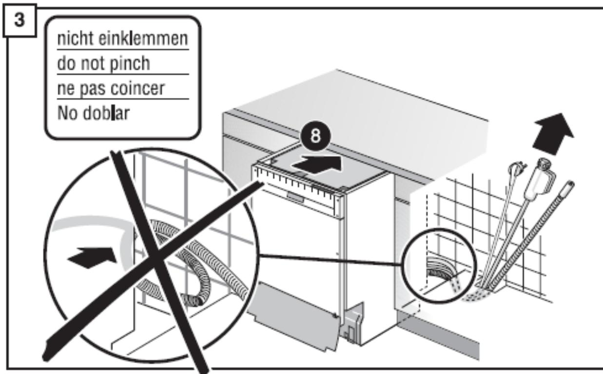
步驟八、將機器由前向後推入定位時，應一邊**推**機器，同時一邊**拉出**管線，
