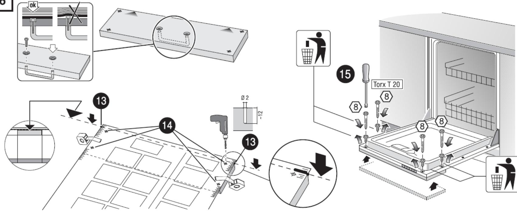
步驟十三、門板內側朝上，施工圖原先所標示刻度位置與門板上緣對齊(圖面凸出門板)，並以膠帶固定施工圖兩側。
