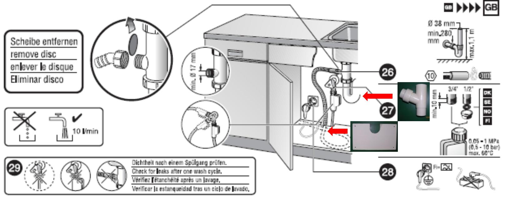
步驟二十六、**安裝排水管**(可利用附贈之塑膠排水三通，安插在原水槽排水管的適當位置)，如直接配置排水管，高度不得高於洗碗機。
