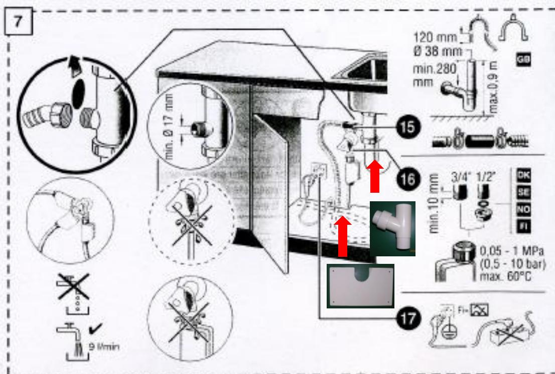
步驟十五、**安裝排水管**(可利用附贈之塑膠排水三通，安插在原水槽排水管的適當位置)，如直接配置排水管，高度不可高於洗碗機。
