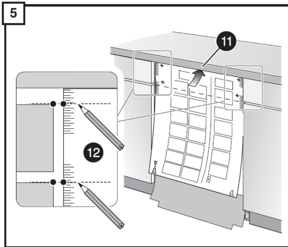
步驟十一、貼上機器隨附之安裝施工圖，圖面上緣切齊檯面
