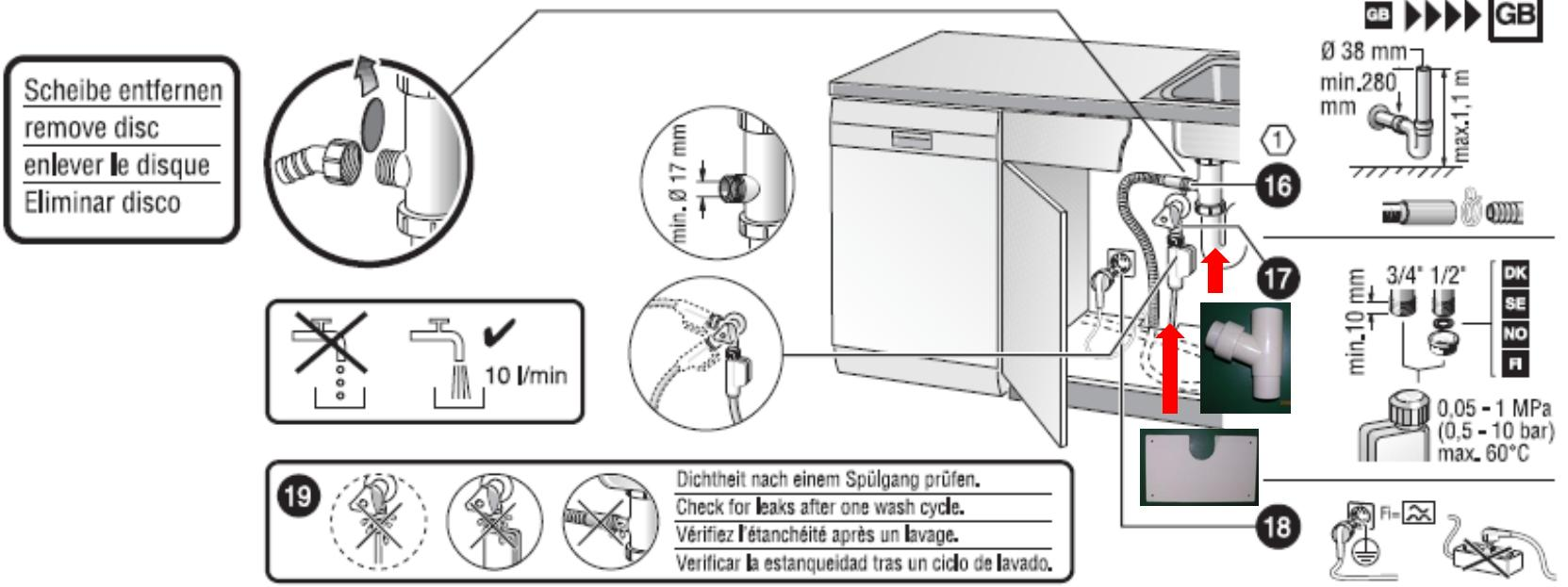
步驟十六、**安裝排水管**(可利用附贈之塑膠排水三通，安插在原水槽排水管的適當位置)，如直接配置排水管，高度不得高於洗碗機。
