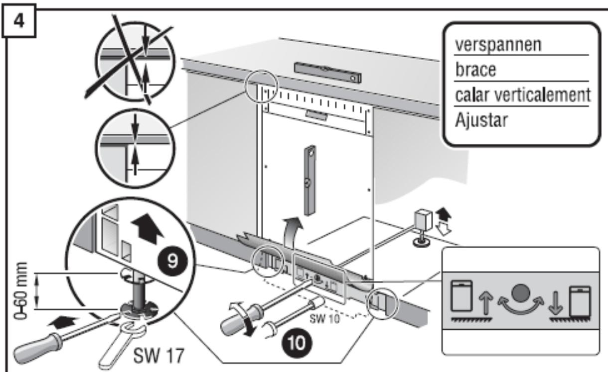
步驟九、機器推入定位後，請調整前方的兩隻調整腳，檯面與機體不可有空隙，
