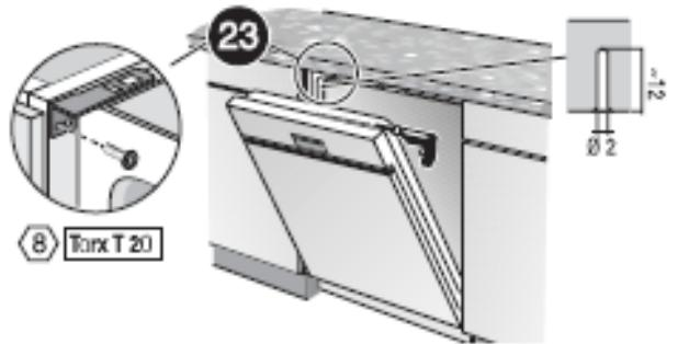
步驟二十三、用**安裝包(8)**之兩顆螺絲旋入機器固定片內，如為層積板檯面向上固定，如為人造石檯面則旋入相鄰廚櫃固定。
