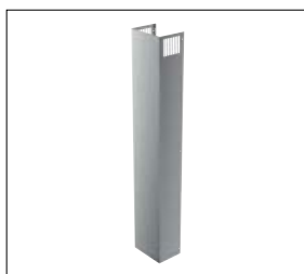
DWZ 0AX5L0: przewód wywiewowy, stal szlachetna. Przedłużenie teleskopowe 1500 mm dla okapów kominowych naściennych. Możliwość wydłużenia całkowitej wysokości urządzenia o 1030 mm. Do obiegu zamkniętego lub otwartego. Przedłużenie szczelinami do pracy w obiegu zamkniętym.
