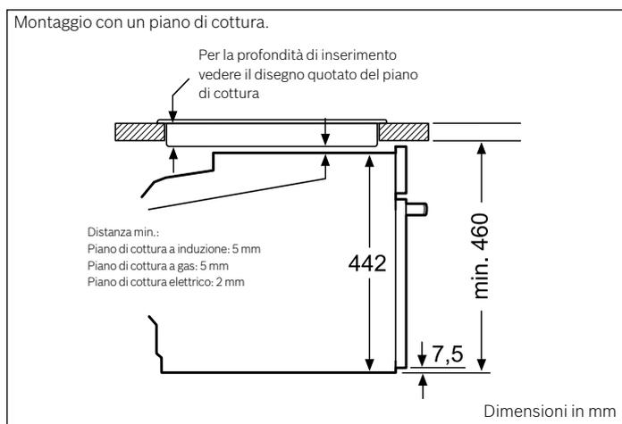
Se l'apparecchio viene montato sotto un piano di cottura deve essere rispettato il seguente spessore del piano di lavoro (event. incl. sottostruttura).
