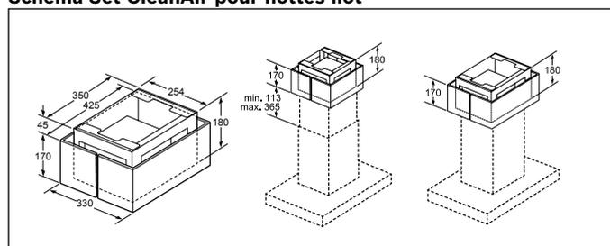
Schéma Set CleanAir pour extracteur d'air
