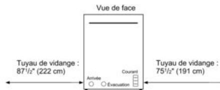
Le boîtier de raccordement électrique et l'arrivée d'eau sont situés sur le devant de l'appareil, l'évacuation est à l'arrière.
