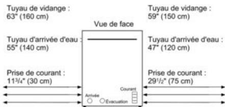
Tous les raccordements à l'arrière de l'appareil.
