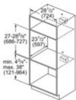
\* Pour des fours individuels installés dans une armoire murale, le boîtier de raccordement peut se situer au-dessus ou au-dessous de l'unité à portée du caniveau de câbles.
