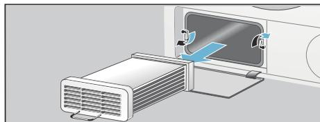
6. 使用水柱沖洗冷凝器的每一面，徹底除去所有棉絮。
