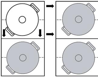
L'ustensile est détecté et dans l'affichage du nouveau foyer, la position de chauffe précédemment sélectionnée et  $\text{L}$  clignotent en alternance.
